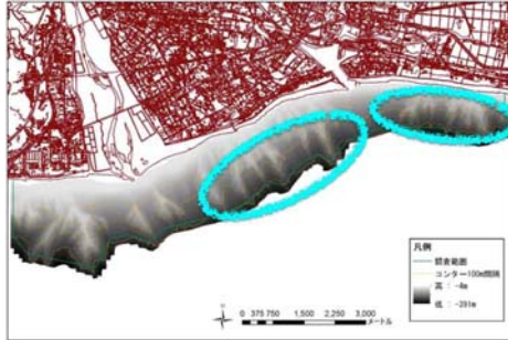
海底地形調査による崖発見箇所
