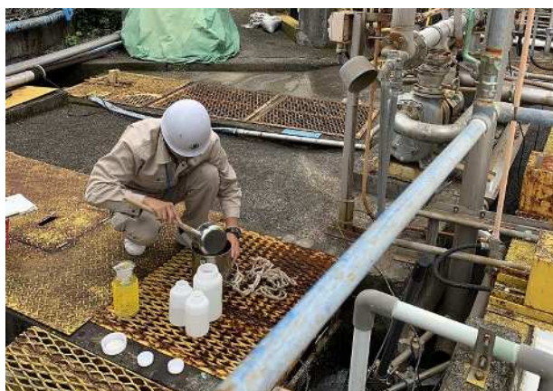
工場排水に対する水質検査
