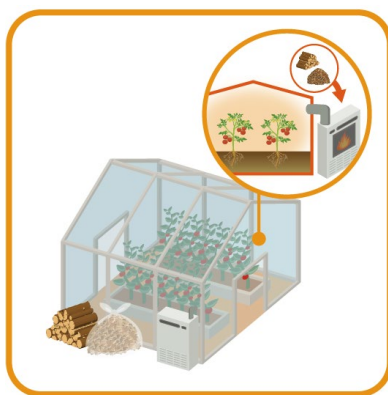
農業用ハウスなどへの バイオマスボイラー導入
