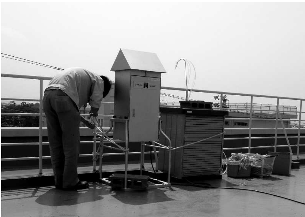
有害大気汚染物質測定の様子(ハイボリュームサンプラーを使用)
