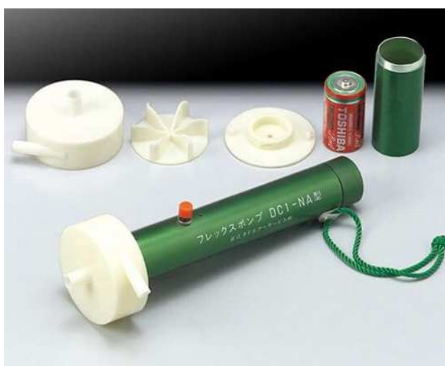
臭気測定に使用するフレックスポンプ
