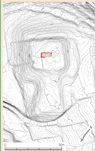
空中レーザー測量による測量図と 地中レーダー探査で確認された反応(赤い部分)
