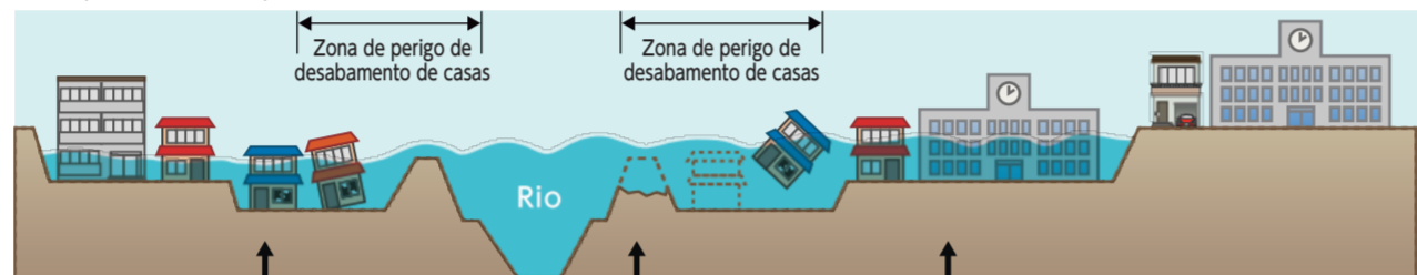
As águas transbordam dos rios, causando inundações em grandes áreas. O dique poderá romper e as casas podem ser destruídas. A inundação atinge também os locais de abrigo.
