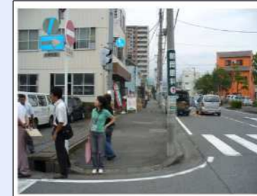
・歩道上への店舗の荷物が危険。誘導ブロックがない。 →荷物撤去して歩道空間を確保、誘導ブロックの設置。
