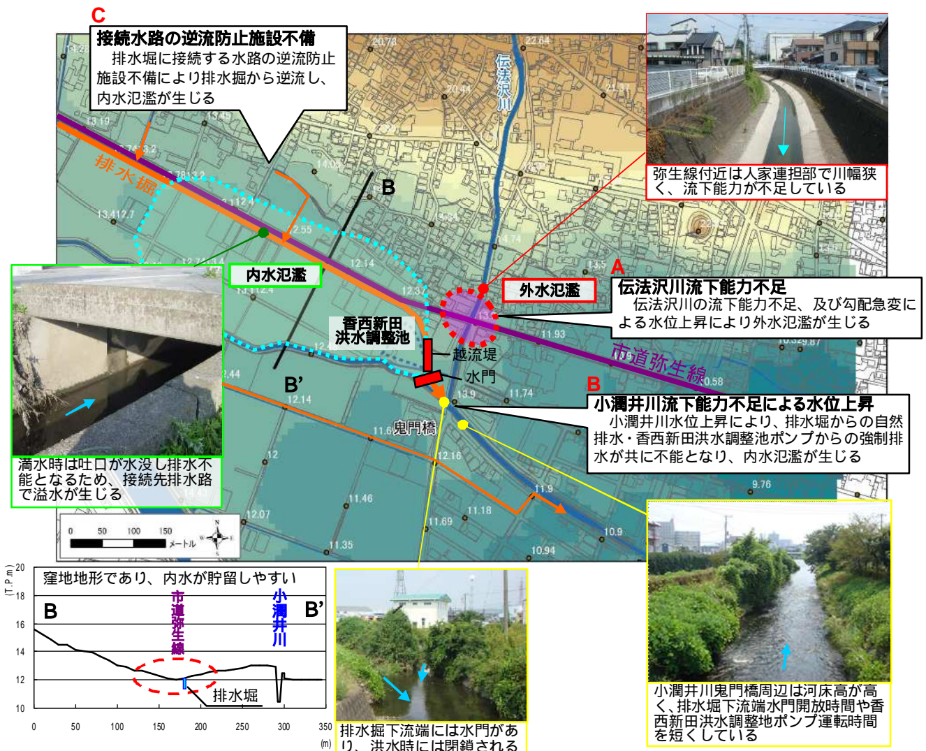
図 2-28：小潤井川・伝法沢川の浸水原因概要図
