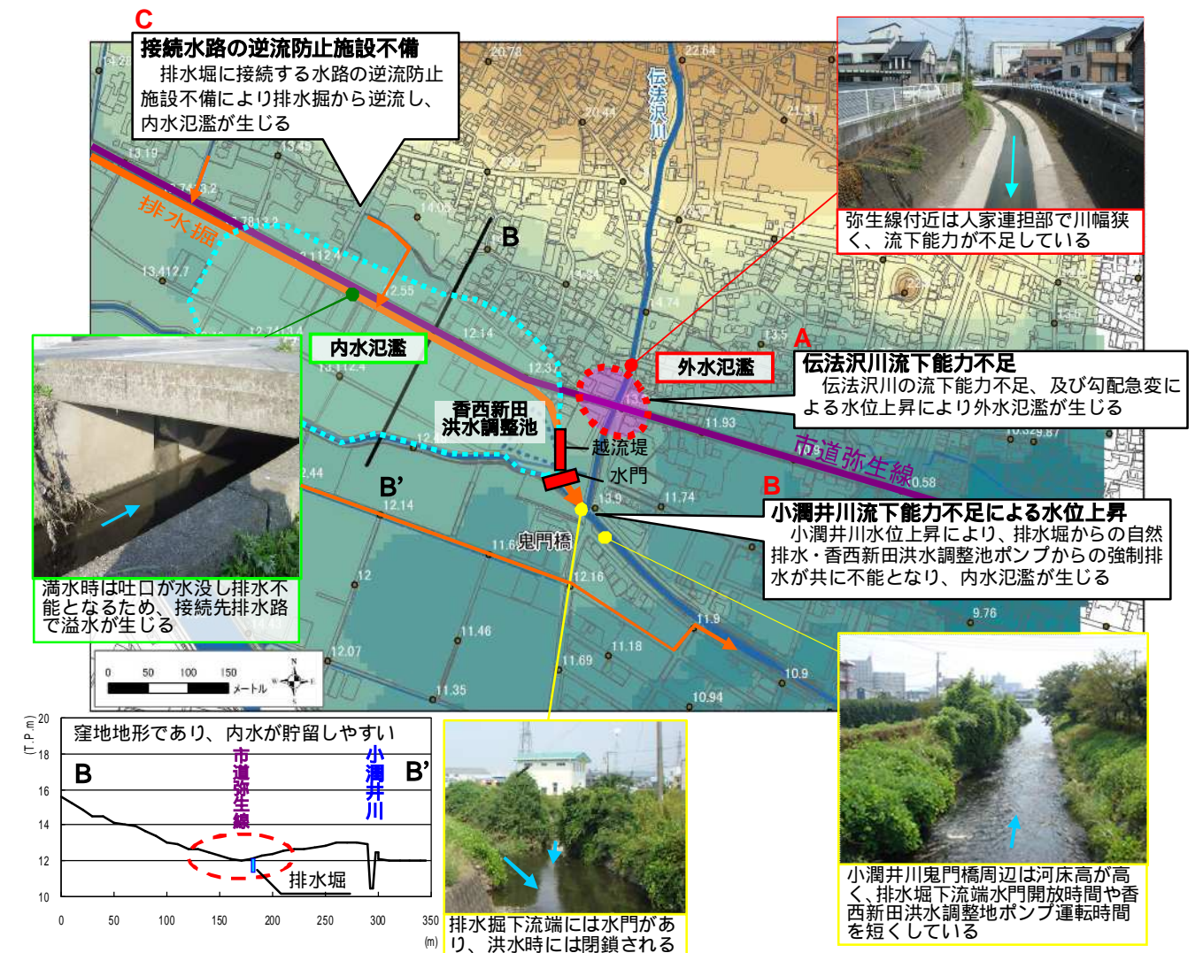
図 2-4：河川や下水などに関連する浸水要因（小潤井川・伝法沢川）
