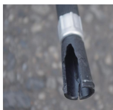
× ノズルの破損
