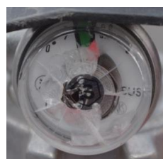
× 指示圧力計の損傷
