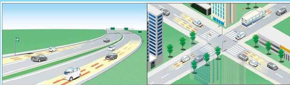
図 6-3 インホイールモーターに走行中に給電するイメージ (出典：国立研究開発法人科学技術振興機構（JST）ウェブサイト)
