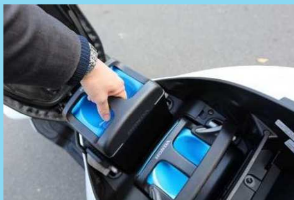
図 6-4 ホンダ製 EV バイク「PCX ELECTRIC」における電池交換の様子 (出典：日経クロステック)
