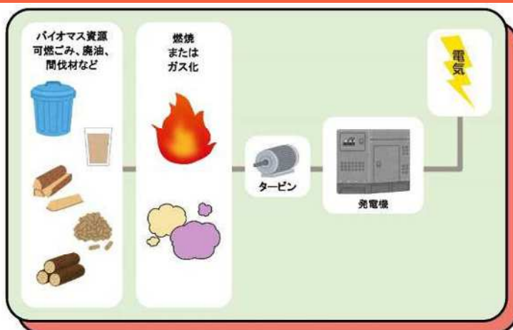
図 3-42 バイオマス利用発電の仕組み
