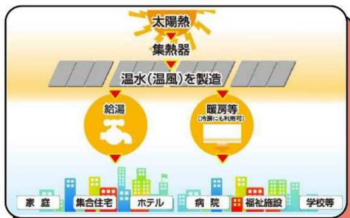
図 3-38 太陽熱発電の仕組み (出典：経済産業省 資源エネルギー庁ウェブサイト)
